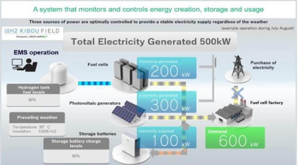
3電池を連携させた当社独自開発のエネルギーマネジメントシステムにより、工場での電力需要データや気象予報データ(将来対応予定)、運転中の機器モニタリング情報を元に電力需要に追随し、太陽電池の発電量の計測から発電パターンを計画します。また、純水素型燃料電池の発電量を計画的に運転調整をしたり、電力の余剰や不足に対し蓄電池を活用する等、最適かつ安定した電力供給を行います。
